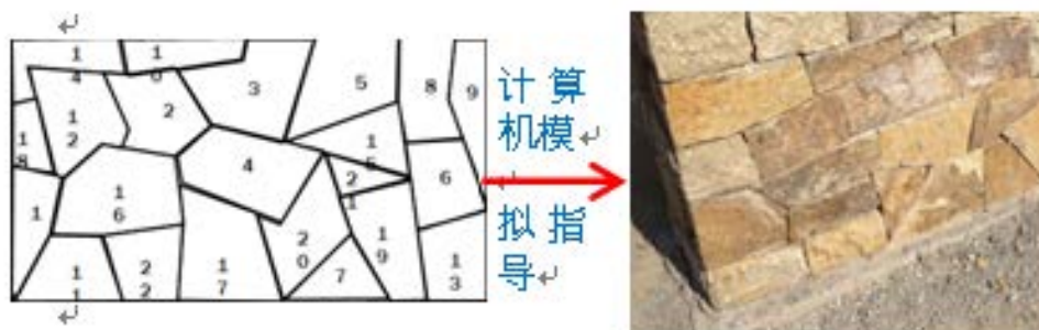
图 4-11 毛石墙砌筑模拟
